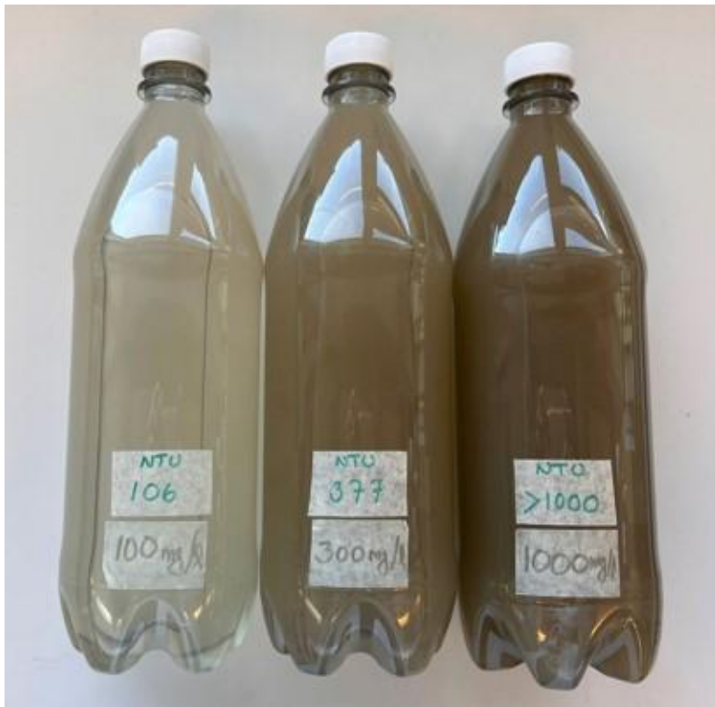
Kuva 17. Kiintoainepitoisuudeltaan ja sameudeltaan erilaisia vesiä muovipulloissa. Pulloihin on merkattu veden kiintoainepitoisuus yksikössä mg/l ja sameus yksikössä NTU. Kuva: Turun Ammattikorkeakoulu.
