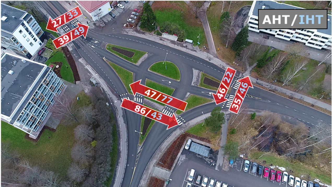
Kuva 3. Aamu- (AHT) ja iltahuipputunnin (IHT) jalankulkija- ja pyöräilijämäärät suojatiellä Asematie – Tunnelitie – Helsingintie -liittymässä.
