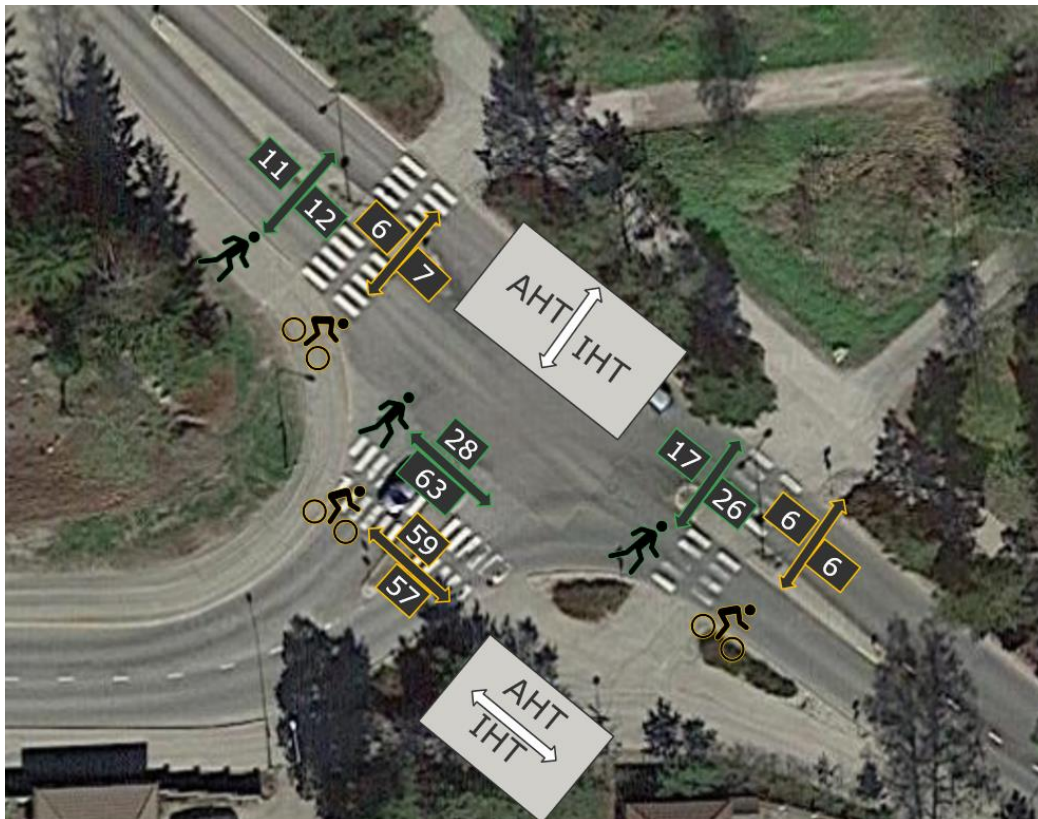
Kuva 4. Aamu- (AHT) ja iltahuipputuntien (IHT) jalankulku- ja pyöräliikennemäärät suoja- tiellä ja pyörätien jatkeella Asematie-Bembölentie -liitytmässä.
